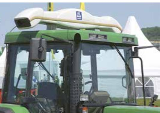
capteurs (N-Sensor ALS) produits par le vendeur de fertilisants azotés Yara. Il est monté sur la cabine d'un tracteur et enregistre la réflectance de la végétation afin de caculer une fertilisation supposé
