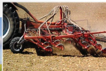
Enfin! Un semis de précision pour vos céréales grâce à notre élément à double parallélogramme avec roue de contrôle et réglage centralisé de la profondeur et du plombage.
