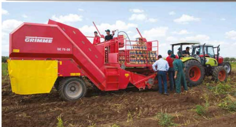
assurent une large polyvalence dans la récolte de plusieurs catégories de productions (plants, consommation, féculé) en adaptant au mieux le choix des équipements de séparation (effilage, déterrage) disposés à l'arrière de la machine.
