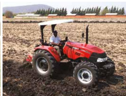
La système à double embrayage optimise le système de transmission et assure des économies de carburant et un rendement énergétique de premier ordre ainsi qu'un fonctionnement continu des outils.
